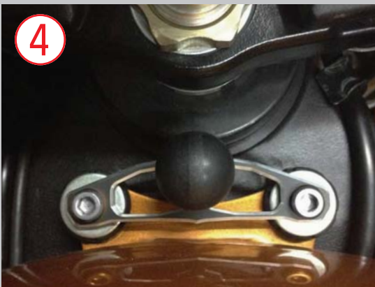
完成です。 ガタつきがないか確認してください。
